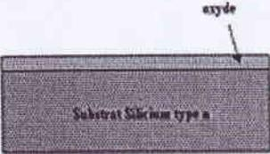
→ (h) Oxydation humide (dépôt du SiO<sub>2</sub> épais pour le 1<sup>er</sup> masque de diffusion)
