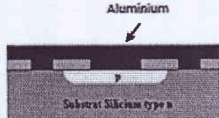
→ (e) Dépôt d'une couche métallique en Aluminium(Al)
