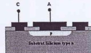
→ (g) Gravure d'Al et prise de contact d'Anode et de Cathode.
